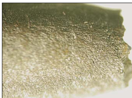
Obr. 4. Povrch po experimentu č. 4, plošná korozie, 25x zvětšeno
