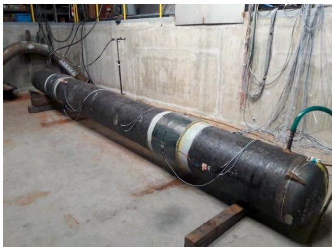
Obr. 1 Potrubní zkušební těleso L = 6000 \text{ mm} , DN 500 s ocelo-kompozitní objímkou a kompozitní vinutou objímkou [1]
