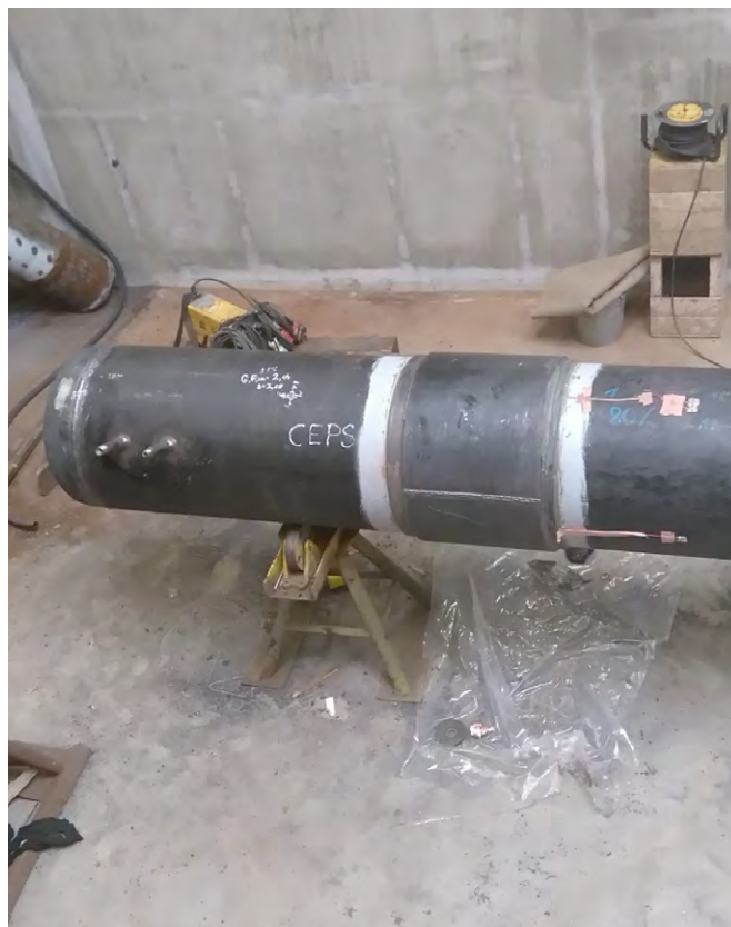
Obr. 2b Ocelová objímka typu A s kompozitní výplní – polopláště s polopáskem na tělese [1]
