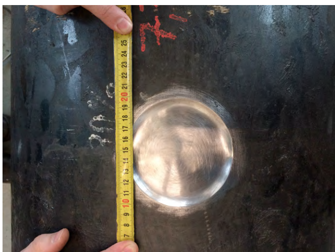
Obr. 5b Vybroušená vada na tělese [1]
